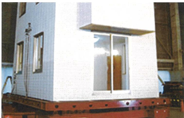
実物大のヘーベルハウスを使った振動台実験を、1998年、2002年、2004年と繰り返し実施。2002年と2004年にはそれぞれ阪神・淡路大震災と新潟中越地震の震度6強・震度7クラスの地震波で加振し、耐震性を検証しました。その結果、いずれの実験においても比較的軽微な損傷で済み、高い耐震性を示しています。
